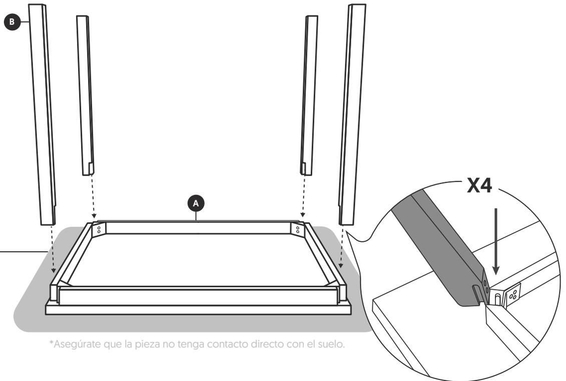
**2** Ahora debes fijar las patas **B** a la cubierta **A** en los orificios de la cubierta, con los tornillos **E** y las arandelas **D** y **C** en el siguiente orden: **C-D-E**
